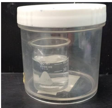
ภาพที่ 3.8 การทดสอบการดูดซับความชื้นของฟิล์มพลาสติก Nylon/PE ฟิล์ม EVA และฟิล์ม ENP ที่อุณหภูมิ 10°C
