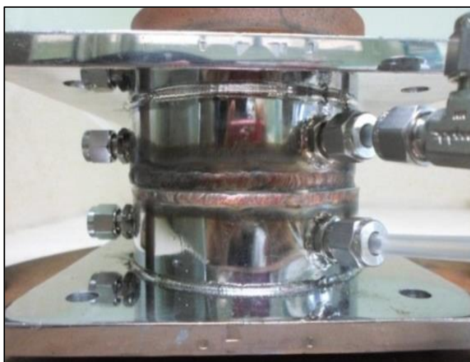
ภาพที่ 3.4 Stainless steel cell ใช้ในการวัด Film permeance to ethanol vapour (FPE)
