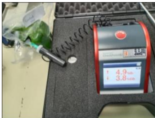
ภาพที่ 3.11 เครื่องวิเคราะห์แก๊ส CO 2 และแก๊ส O 2 (Handheld gas analyser) รุ่น Checkpoint3 (PBI. Dansensor, Denmark) ที่ห้องปฏิบัติการเทคโนโลยีพลาสติก MTEC
