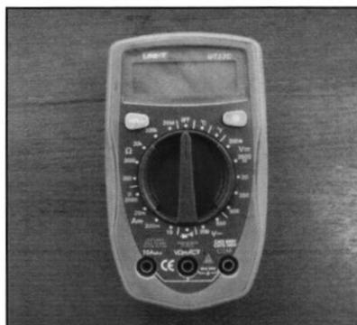
ภาพที่ 4.30 โวลต์มิเตอร์สำหรับวัดแรงดันไฟฟ้าของไดนาโมมิเตอร์
