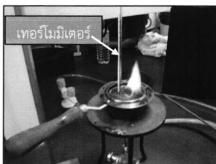
ภาพที่ 4.17 ชุดอุปกรณ์วิเคราะห์หาจุดวาบไฟและจุดติดไฟ
