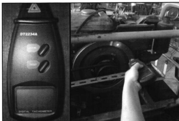
ภาพที่ 4.25 อุปกรณ์วัดรอบการทำงานของเครื่องยนต์
