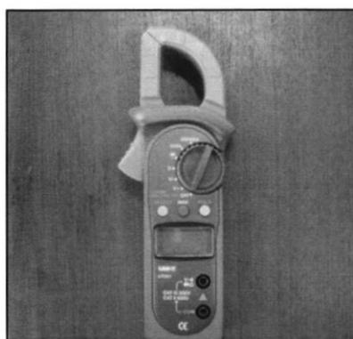
ภาพที่ 4.31 แอมป์มิเตอร์สำหรับวัดกระแสไฟฟ้าของไดนาโมมิเตอร์
