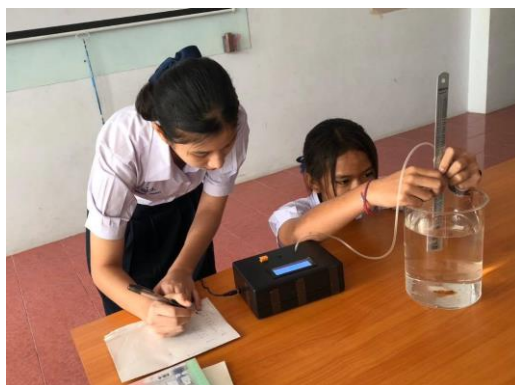
ภาพที่ 3.5 การทดลองหาความหนาแน่นของของเหลวโดยมาโนมิเตอร์แบบ Arduino
