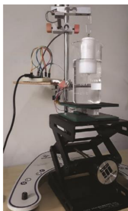
ภาพที่ 2.12 ชุดทดลองแรงลอยตัวโดยใช้ Arduino ต่อเข้ากับโหนดเซลล์ ที่มา: Espindola et al. (2018)
