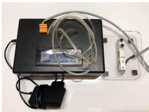
ภาพที่ 3.3 มาโนมิเตอร์แบบดิจิตอลด้วย Arduino บอร์ด
