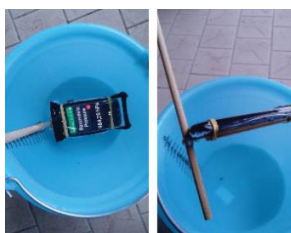
ภาพที่ 2.4 การทดลองหาความดันในของเหลวด้วยสมาร์ทโฟน ที่มา: Vieyra et al. (2017)
