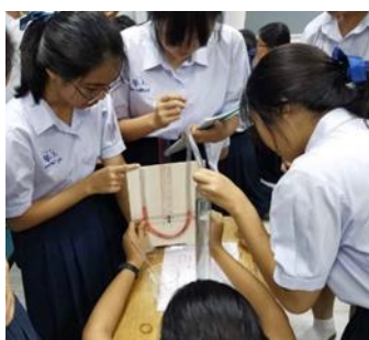
ภาพที่ 1.1 มาโนมิเตอร์แบบหลอดตัว U ในห้องเรียน
