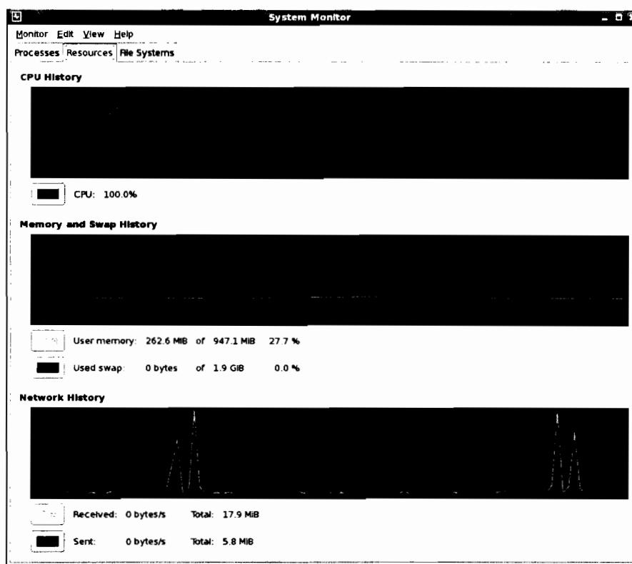
ภาพที่ 4.30 การใช้งานทรัพยากรของเครื่องคอมพิวเตอร์แม่บอร์ดข่ายขณะที่ทำการประมวลผลคะแนน
