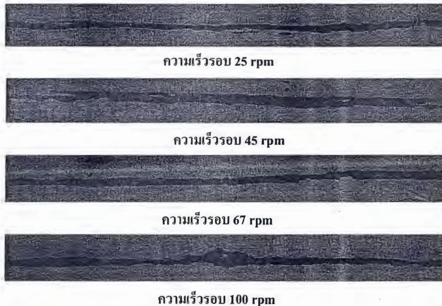
**ภาพที่ 5.12** ตัวอย่างลักษณะของรอยเชื่อมที่เกิดจากการเชื่อมด้วยหัวเชื่อมแบบในแนวแกนโดยรอบท่อมน 2.8° กับ 0° ที่ความเร็วอบต่างกัน
