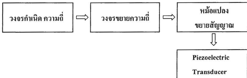
ภาพที่ 2.3 การทำงานของเครื่องกำเนิดสัญญาณความถี่ (Ultrasonic Generator)
