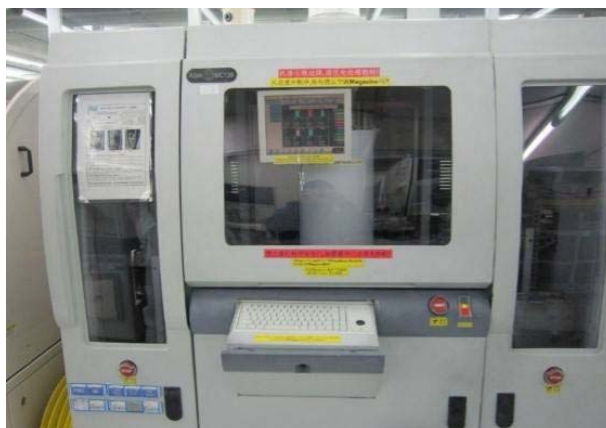
ภาพที่ 2.11 ลักษณะเตาอบ Post Mold Cure ที่มา: Maynards (2019: Website)
