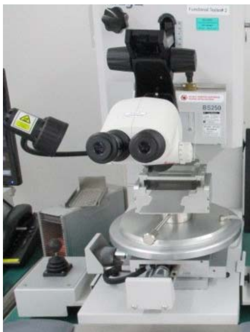
ภาพที่ 4.8 เครื่องทดสอบค่าแรงดึงและแรงเฉือนในกระบวนการเชื่อมลวดทองคำ
