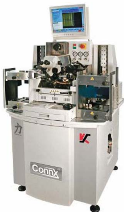
ภาพที่ 2.6 ลักษณะของเครื่องเชื่อมลวดทองคำ (Gold wire Bonding Machine)
