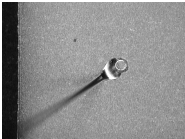
ภาพที่ 4.7 ลักษณะของ Second bond
