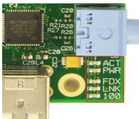
ภาพที่ 2.5 LED สถานะของบอร์ด อยู่ภายในบริเวณกรอบสีแดง [3]
