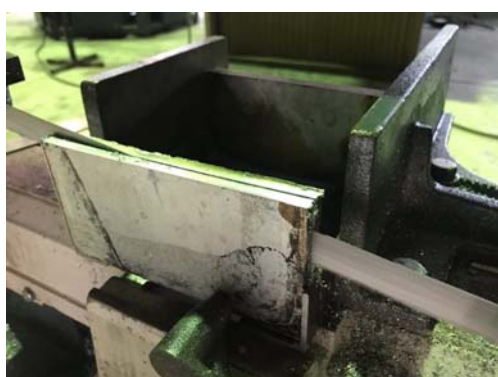
(ก) การตัดแผ่นอะลูมิเนียมหล่อกิ่งแข็ง เกรด 6063
