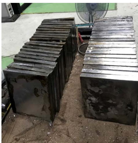
ภาพที่ 3.2 อะลูมิเนียมหล่อกึ่งของแข็ง SSM 6063
