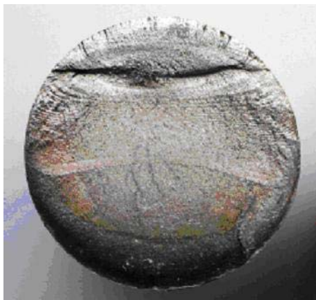
ภาพที่ 2.8 การเสียหายเนื่องจากการล้า [36]
