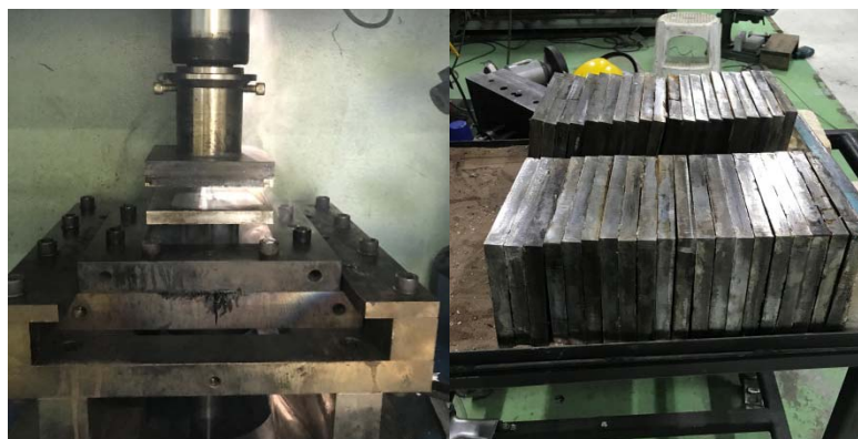
ภาพที่ 3.21 การหยิบชิ้นงานออกจากแม่พิมพ์
