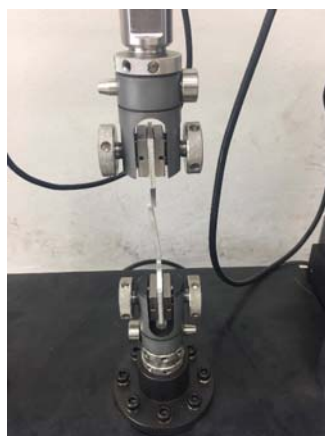
ภาพที่ 3.36 การทดสอบความล้า
