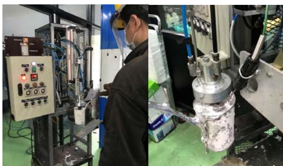
ภาพที่ 3.18 การปล่อยฟองแก๊สไนโตรเจนผ่านแท่งกราฟไฟต์
