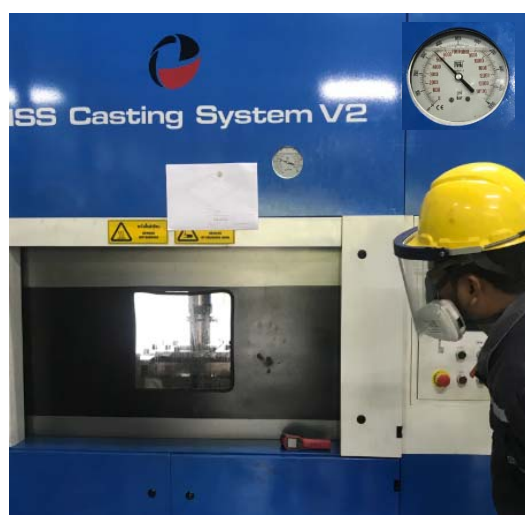
ภาพที่ 3.20 อัดด้วยความดันประมาณ 350 บาร์
