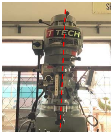
ภาพที่ 3.26 การปรับมุมเอียงของเครื่องมือเชื่อม
