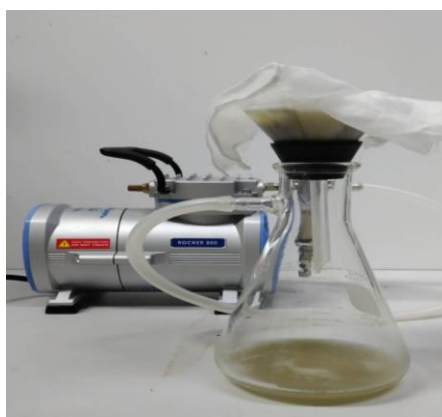
ภาพที่ 60 การกรองตัวอย่างน้ำเชื่อมที่ได้จากข้าวระยะเฒ่าด้วยถ่านกัมมันต์ (activated carbon)
