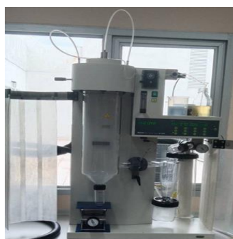
ภาพที่ 33 เครื่องทำแห้งแบบพ่นฝอย (Spray dryer) ที่ใช้ในการทำแห้งน้ำเชื่อมจากแป้งข้าว
