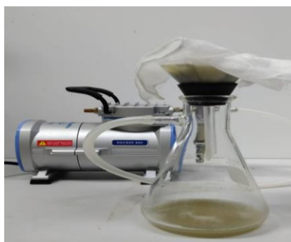
ภาพที่ 32 การกรองตัวอย่างน้ำเชื่อมที่ได้จากข้าวจ้าวระยะเฝ้าด้วยถ่านกัมมันต์ (activated carbon)
