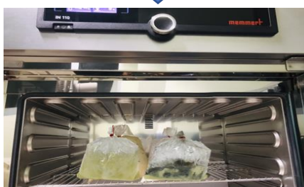
ภาพที่ 27 ขั้นตอนการหมักอาหารแข็งจากข้าวระยะเม่าด้วยสปอร์เชื้อรา
