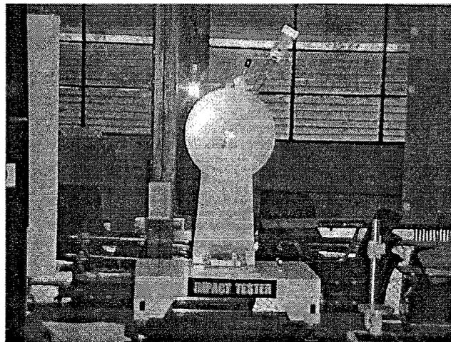
รูปที่ 3.25 เครื่องทดสอบแรงกระแทกยี่ห้อ INTRO รุ่น 4J
