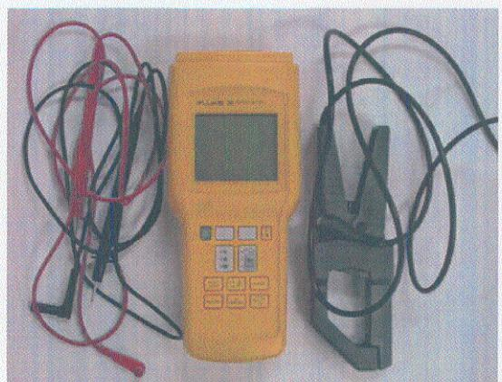
รูปที่ 4.2 มิตอร์วัดกำลังไฟฟ้า
