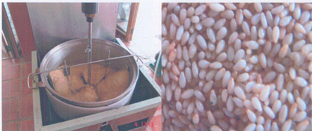
รูปที่ 5.4 แสดงลักษณะเมล็ดคงที่คั่วสุกแล้ว เมื่อคั่วงาน 4 กิโลกรัม นาน 31 นาที ด้วยเครื่องคั่ว ตามแบบ
