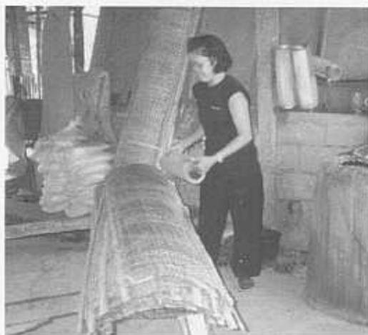
รูปที่ 18 อุปกรณ์เก็บแผ่นข้าวสุกทำด้วยท่อ PVC และฟองน้ำ
